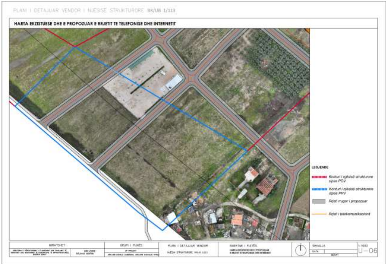
Figura 20_Skema e propozuar e rrjetit të telefonisë dhe internetit
